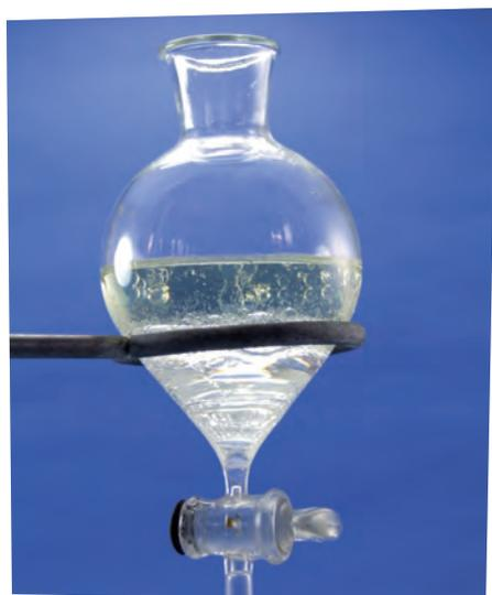
▲ **Fig. 12.** El embudo de decantación permite separar agua y aceite.
